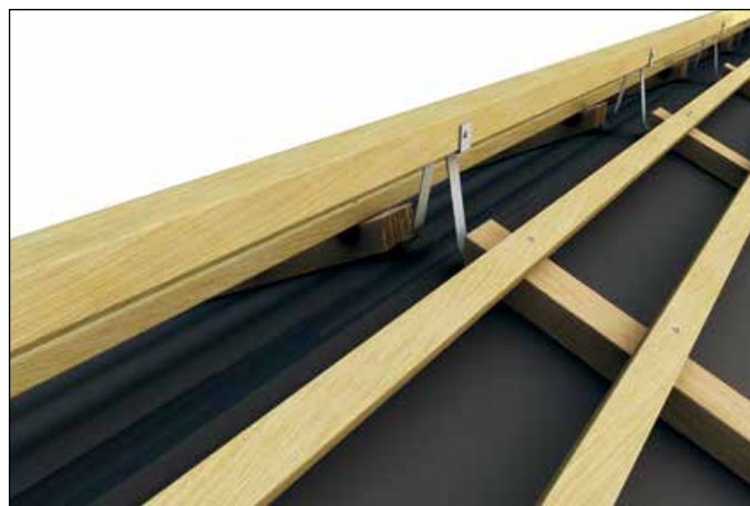
1. možnost: slemenska letev – namestitev na jekleni nosilec.
