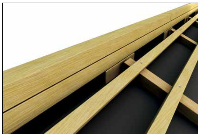
2. možnost: slemenska letev – namestitev na leseno podkonstrukcijo.
