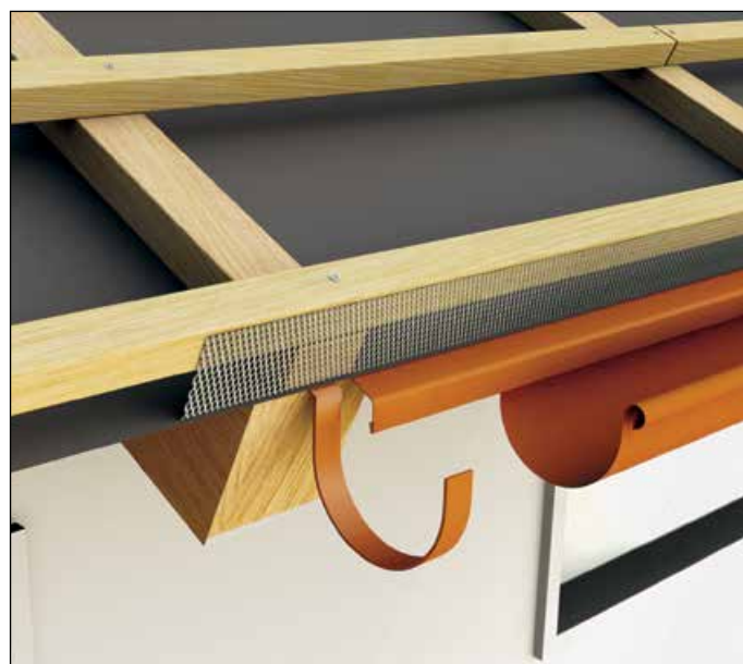
2. možnost: zaščitna odkapna obroba se konča v žlebu.
