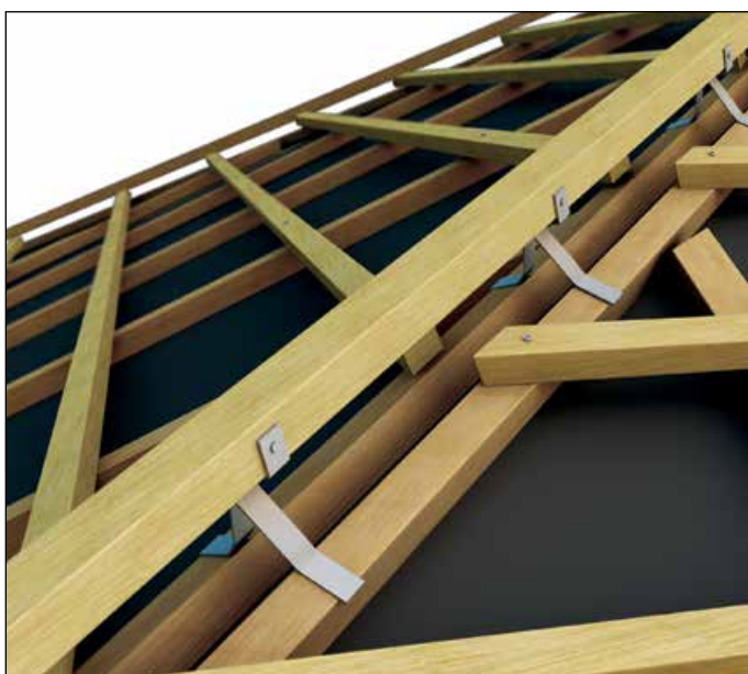
1. možnost: grebenska letev – namestitev na jekleni nosilec.
