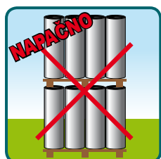
Ne shranjujte izdelka na paletah, ki so naložene ena na vrhu druge. Preprečite oblaganje izdelka z neenakomerno razporeditvijo bremena.
